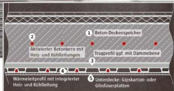
Die Klimadecke kann im Beton gespeicherte Energie großflächig in den Raum abgeben. Wärme oder Kälte wird über Wasserleitungen (rot) transportiert.
