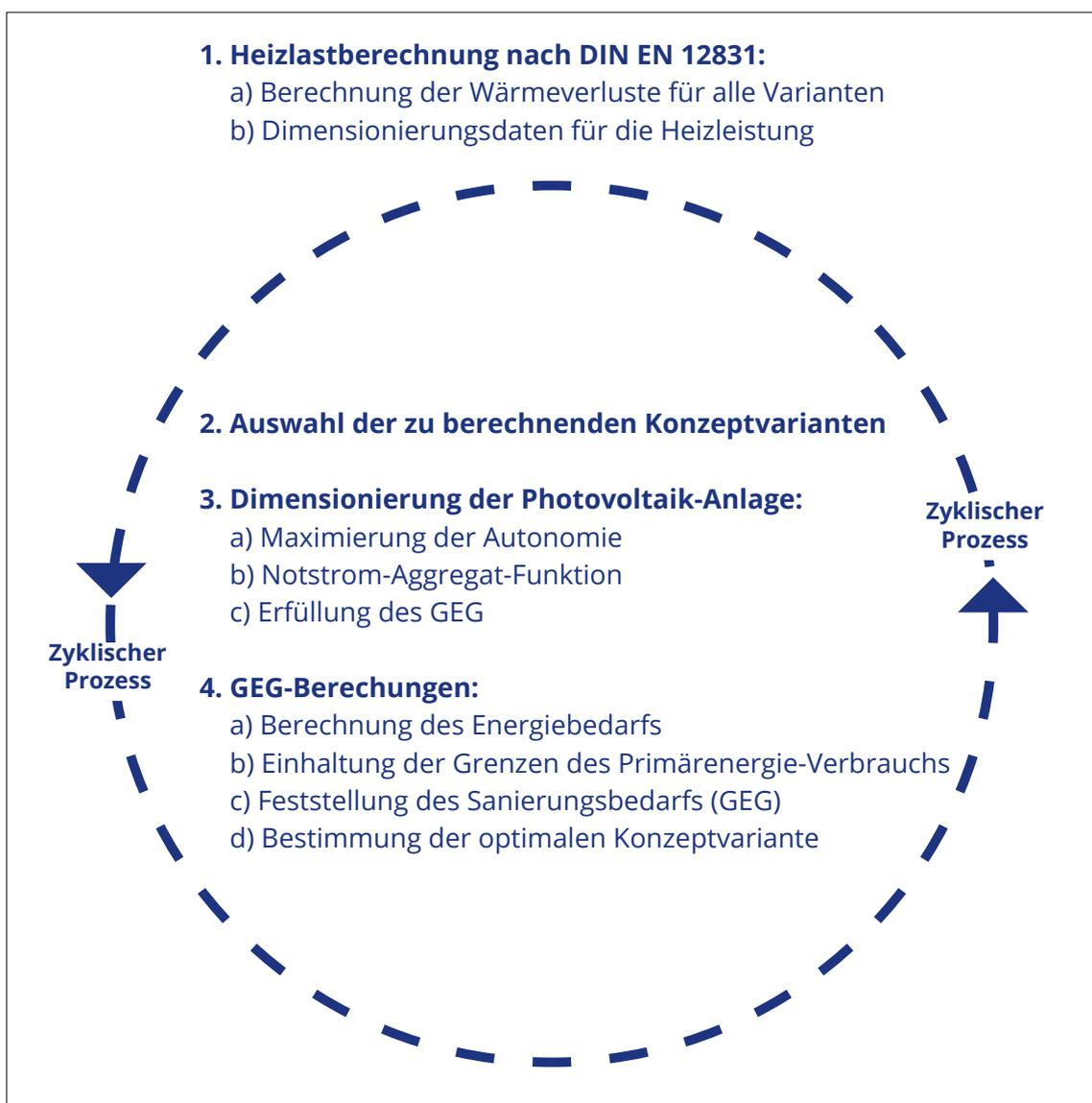
Es beginnt mit der Heizlastberechnung für das Gebäude nach DIN EN 12831. Für Neubauten liegen die Daten aus der Planung vor. Im Falle einer Altbausanierung müssen die benötigten Daten im Rahmen einer Vor-Ort-Beratung erfasst werden.
