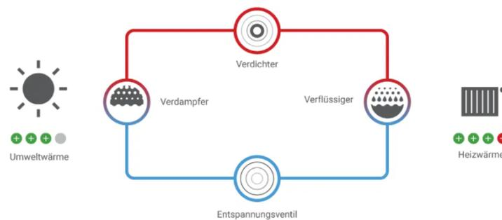
Abbildung 2: Wärmepumpenkreisprozess (<https://heizung.de/waermepumpe/wissen/die-waermepumpe-funktion-kurz-und-verstaendlich-erklart/>)
